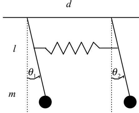
Fig. 6. Două pendule cuplate printr-un arc elastic.
