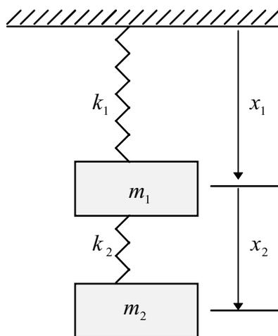
Fig. 8. Mase cuplate prin legături elastice
