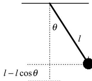
**Fig. 1.** Pendulul plan simplu
